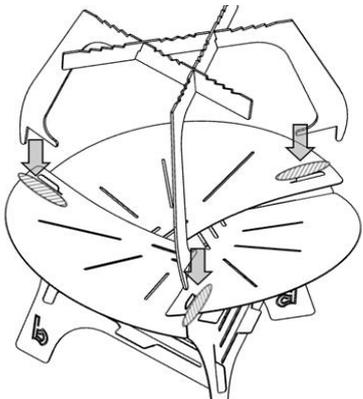
火炉裏の所定の位置(左図の楕円マークの位置)に上から置きます。所定の位置以外への取り付けはお控え願います。また、火炉裏とは完全に固定しません。脚、火床の角度を利用して、外れにくい位置での設置となります。取扱い時にはご注意ください。
