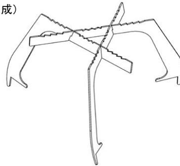
火炉裏の脚と火床はデザイン性も含めた傾きを持たせています。上に乗せる五徳もその角度に合わせて安定して設置できるようにしています。**組み立ては上図通り方向を合わせて切り込み(切欠き)部を順番にはめ込んで下さい。**
